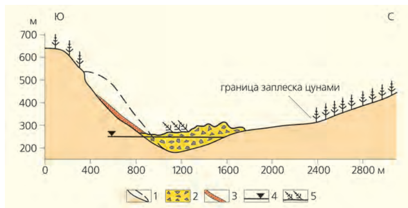
Поперечный профиль оползня. 1 — первоначальная поверхность склона, 2 — оползневое тело, 3 — шлейф осипей на поверхности скольжения оползня, 4 — уровень воды в водохранилище на момент события, 5 — наклонные деревья, сползшие со склона («пьяный лес»).
